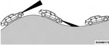
مثال على وحدة التحكم في السرعة الثابتة المهيمنة (ACC) على المرتفعات
