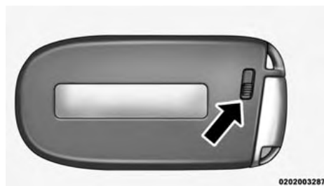
المزلاج الميكانيكي الموجود بالجزء الخلفي من حافظة المفاتيح
